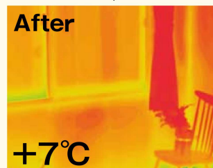
+7°C 今ある窓+内窓(インプラス) / 単板ガラス3mm+Low-E複層ガラス 5°C 30°C サーモグラフィ撮影条件 室外温度0°C、室内温度20°C
